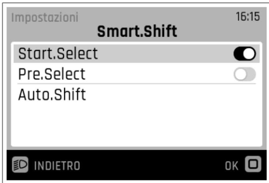
Con Pinion, potete sempre cambiare marcia in modo rapido e preciso in qualsiasi situazione. La tecnologia Smart.Shift consente di utilizzare diverse modalità di cambio elettrico: è possibile cambiare manualmente e impostare la marcia con Start.Select, oppure utilizzare il cambio marcia semiautomatico con Pre.Select quando non si pedala. Con Auto.Shift, MGU cambia marcia in modo completamente automatico in qualsiasi situazione, anche mentre si pedala.
