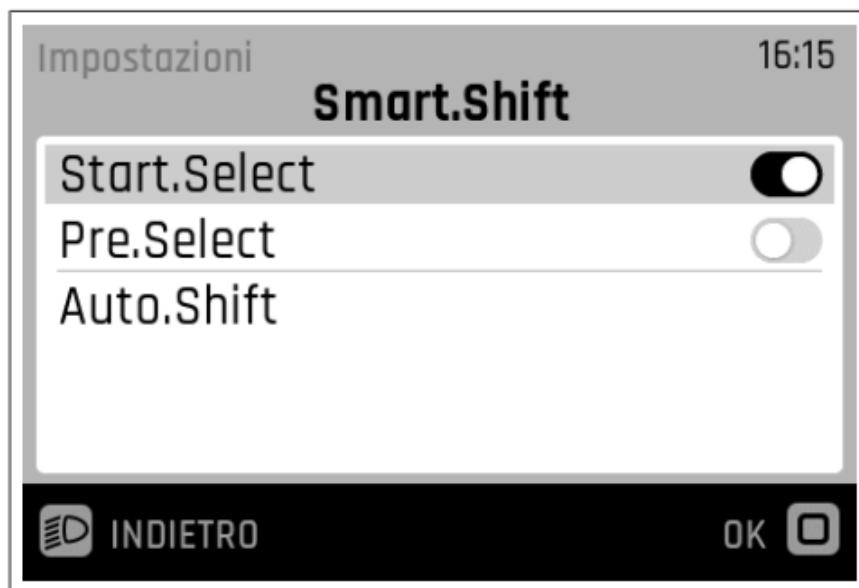
Con Pinion cambias en cualquier situación de forma duraderamente rápida y precisa. La tecnología Smart.Shift te permite emplear diversos modos eléctricos de cambio: Cambiar de marcha manualmente y establece tu marcha con Start.Select o utiliza Pre.Select para cambios de marcha semiautomáticos cuando no estés pedaleando. Con Auto.Shift, la MGU cambia de marcha automáticamente en cualquier situación, incluso bajo carga de pedaleo.
