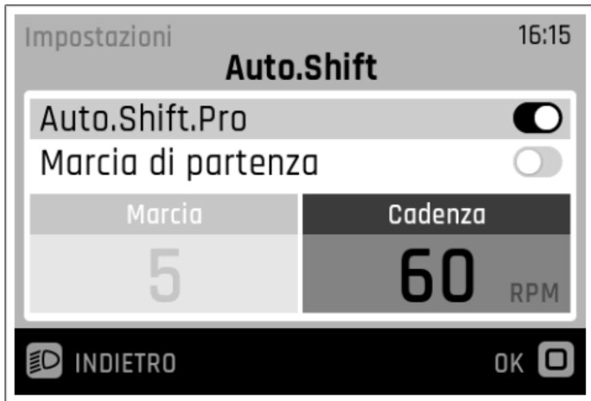
In modalità Auto.Shift, MGU passa alla marcia appropriata in base alla cadenza desiderata, anche durante la pedalata. Quando la funzione Auto.Shift è attivata, è possibile aumentare o diminuire la cadenza desiderata a passi di 5 utilizzando i due pulsanti dell'unità di controllo (ad esempio TE1 o Remote E-Shift).
