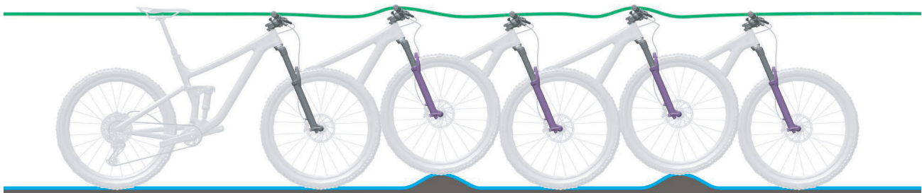
Abbildung 99: Optimales Fahrverhalten der Gabel
