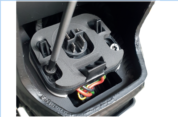
Abbildung 48: Akkuhalter Schrauben lösen
