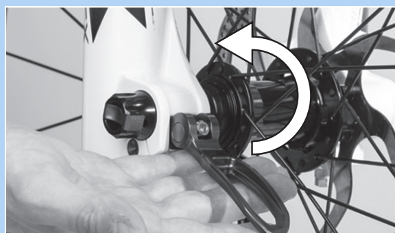
Abbildung 60: Schnellspannhebel in Pfeilrichtung drücken
