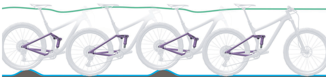
Abbildung 101: Optimales Fahrverhalten des Hinterbau-Dämpfers
