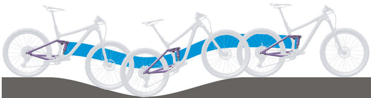
Abbildung 21: Optimales Fahrverhalten des Hinterbau-Dämpfers im hügeligen Gelände
