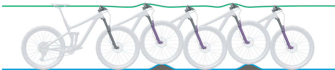
Abbildung 11: Optimales Fahrverhalten der Gabel
