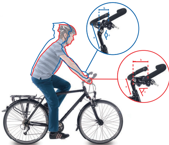
Abbildung 86: Citybike (blau) und Trekkingrad Position (rot) durch Winkeländerung
