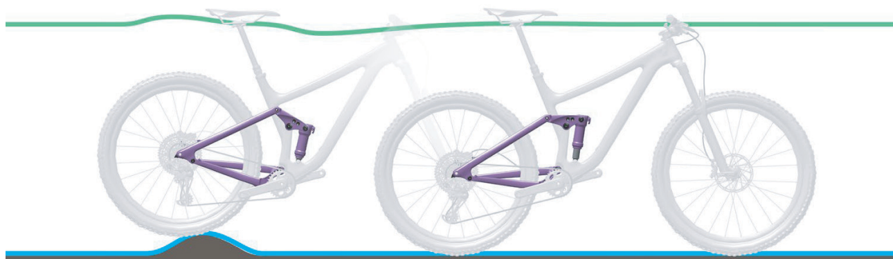
Abbildung 103: Optimales Fahrverhalten des Hinterbau-Dämpfers bei Unebenheiten
