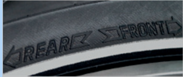
Abbildung 97: Laufrichtungspfeil auf MTB-Reifen
