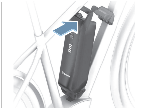
Abbildung 167: PowerPack Akku nach oben klappen
