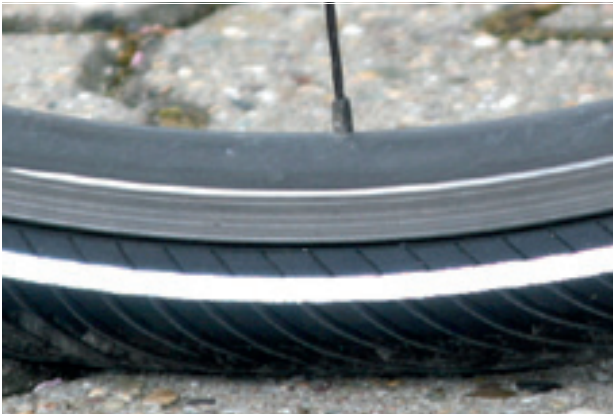
Abbildung 125: Korrekter Fülldruck. Der Reifen ist unter der Last des Körpergewichts kaum verformt.
