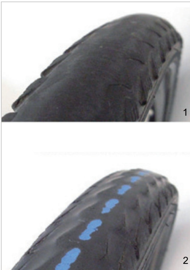
Abbildung 185: Reifen ohne Profil, der gewechselt werden kann (1) und Reifen mit durchscheinendem Pannenschutz (2), der gewechselt werden muss
