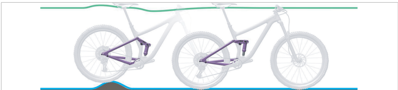
Abbildung 140: Optimales Fahrverhalten des Hinterbau-Dämpfers bei Unebenheiten
