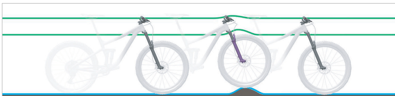
Optimales Fahrverhalten der Gabel bei Unebenheiten
