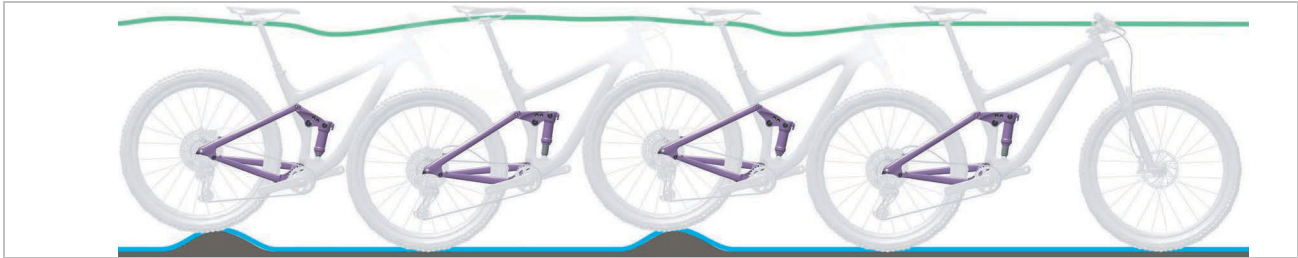
Abbildung 138: Optimales Fahrverhalten des Hinterbau-Dämpfers
