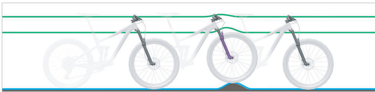
Abbildung 137: Optimales Fahrverhalten der Gabel bei Unebenheiten
