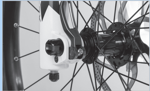
Abbildung 215: Spannkraft des Schnellspanners einstellen
