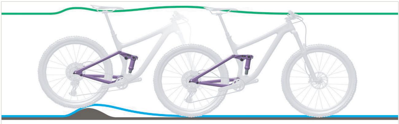
Abbildung 277: Zu harte Dämpfung des Hinterbau-Dämpfers bei Unebenheiten
