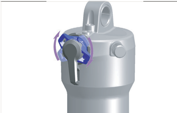
Abbildung 174: Druckstufen-Einsteller härter einstellen
