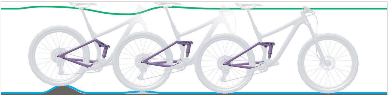
Abbildung 271: Zu schnelles Ausfedern des Hinterbau-Dämpfers
