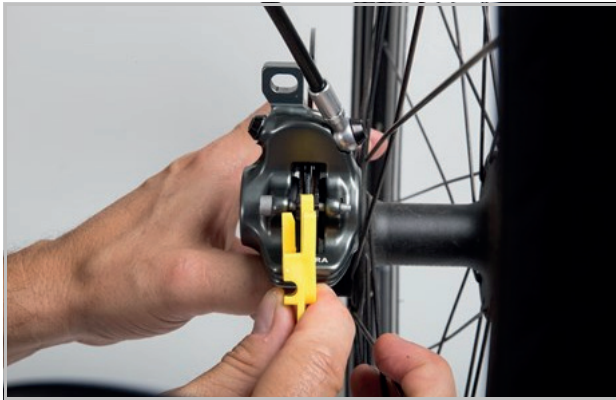
Abbildung 199: Bremsbelag im eingebauten Zustand mithilfe der Transportsicherung prüfen
