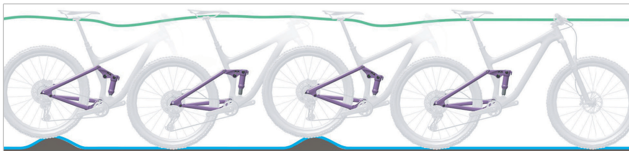
Abbildung 150: Optimales Fahrverhalten des Hinterbau-Dämpfers
