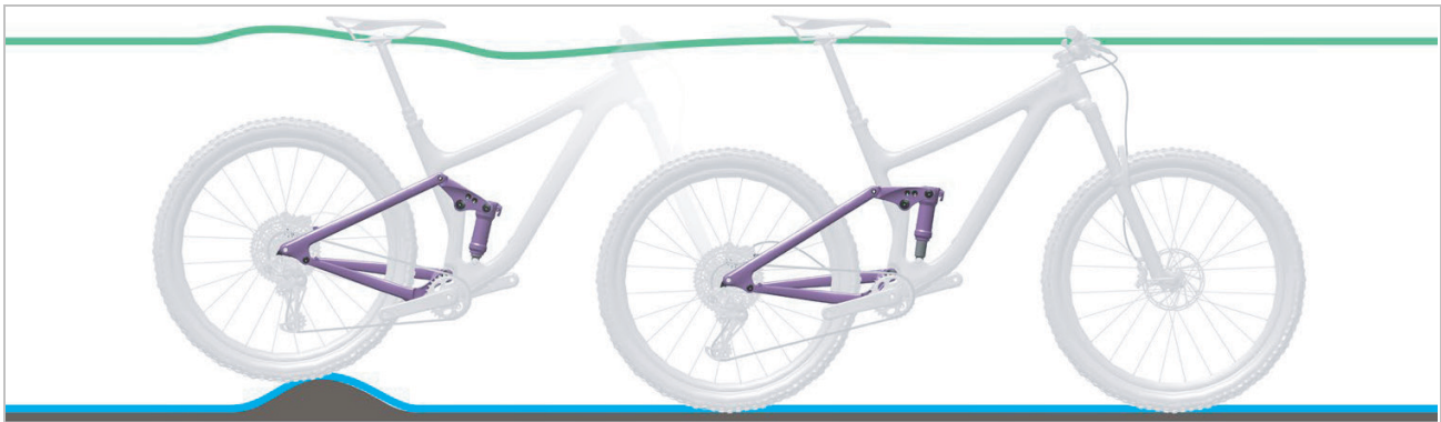
Abbildung 170: Optimales Fahrverhalten des Hinterbau-Dämpfers bei Unebenheiten
