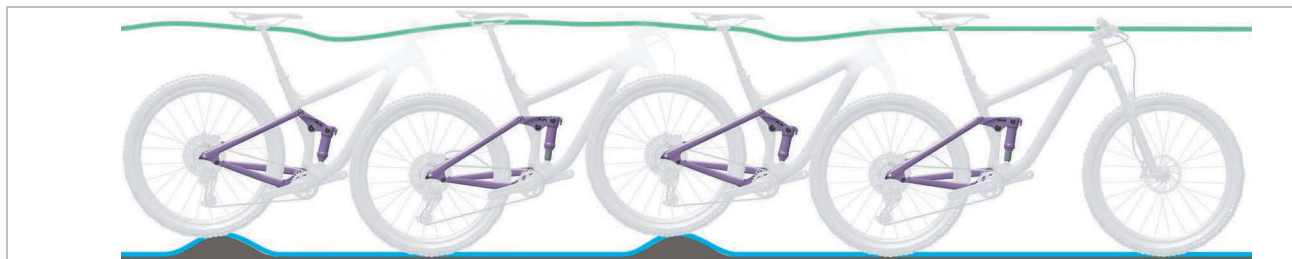
Abbildung 138: Optimales Fahrverhalten des Hinterbau-Dämpfers
