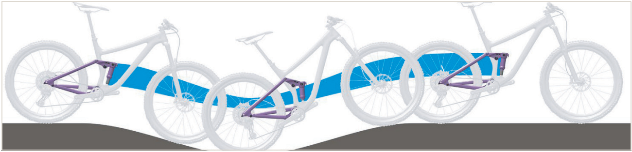
Abbildung 259: Zu weiche Federung des Hinterbau-Dämpfers am Berg
