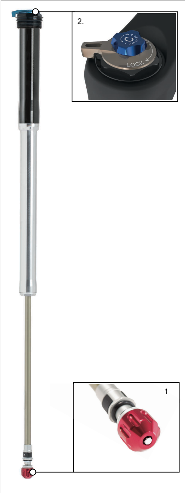
Abbildung 26: Bedienelemente des LORC-PCS
