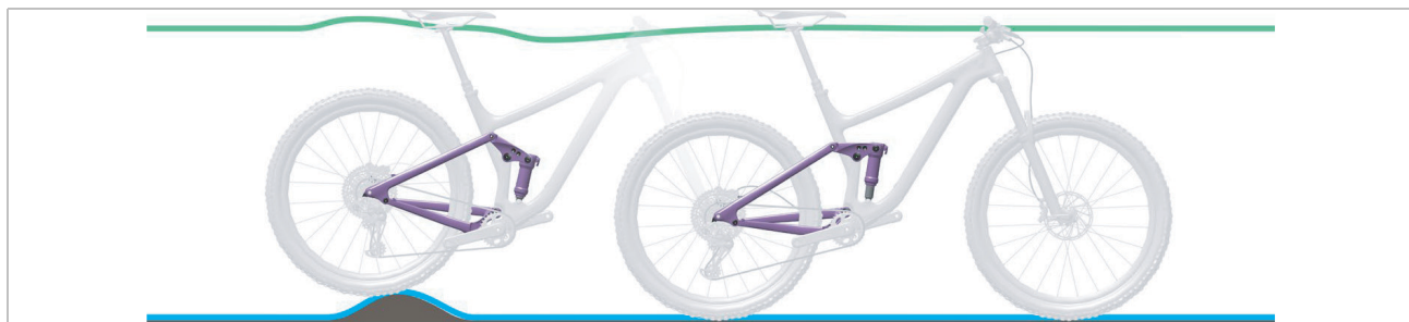
Abbildung 140: Optimales Fahrverhalten des Hinterbau-Dämpfers bei Unebenheiten
