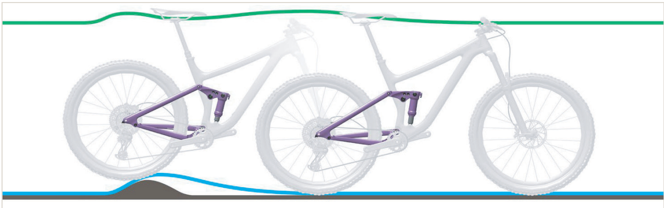
Abbildung 269: Zu harte Dämpfung des Hinterbau-Dämpfers bei Unebenheiten
