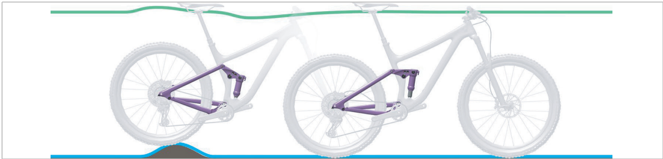
Abbildung 7: Optimales Fahrverhalten des Hinterbau-Dämpfers bei Unebenheiten
