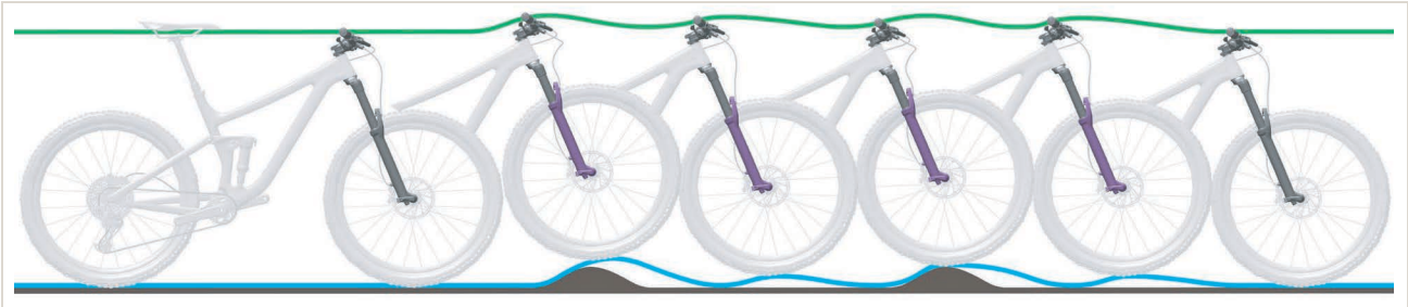
Abbildung 231: Zu schnelles Ausfedern der Federgabel
