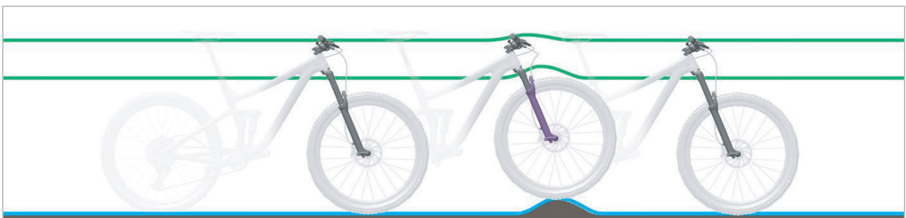
Optimales Fahrverhalten der Gabel bei Unebenheiten
