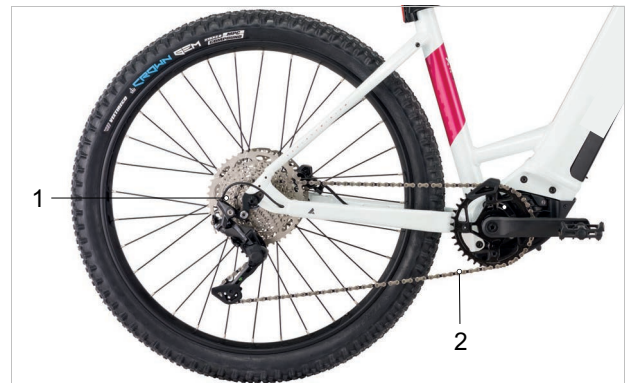
Abbildung 44: Schema Kettenantrieb mit Kettenschaltung
