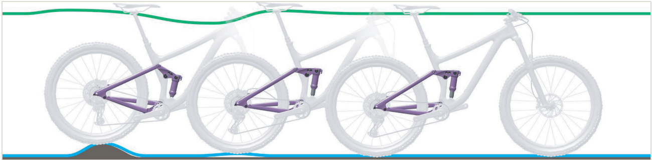
Abbildung 263: Zu schnelles Ausfedern des Hinterbau-Dämpfers
