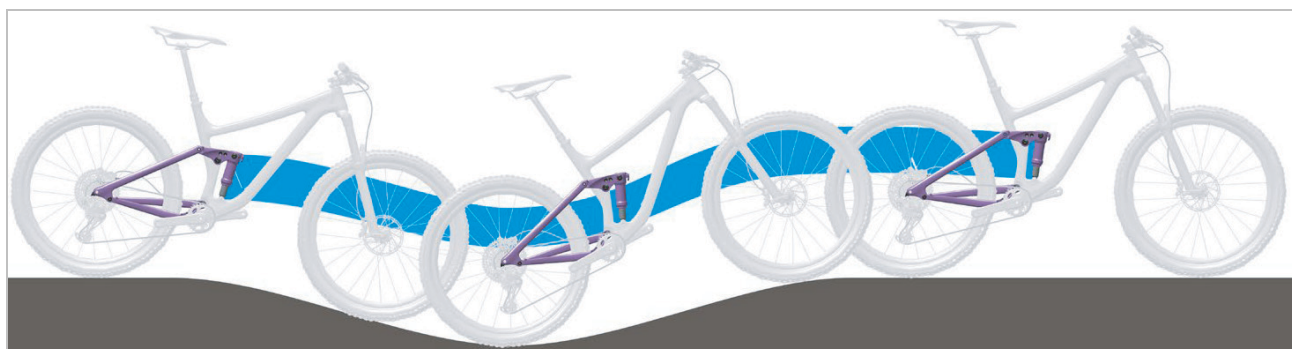
Abbildung 6: Optimales Fahrverhalten des Hinterbau-Dämpfers im hügeligen Gelände
