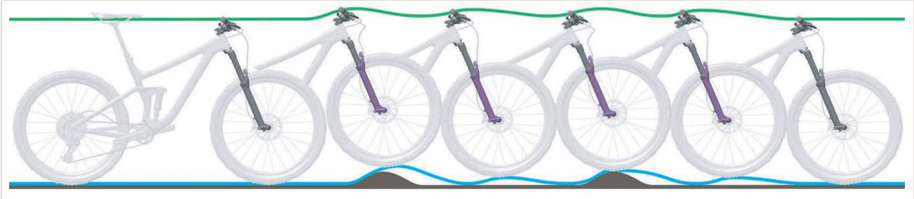
Abbildung 245: Zu schnelles Ausfedern der Federgabel
