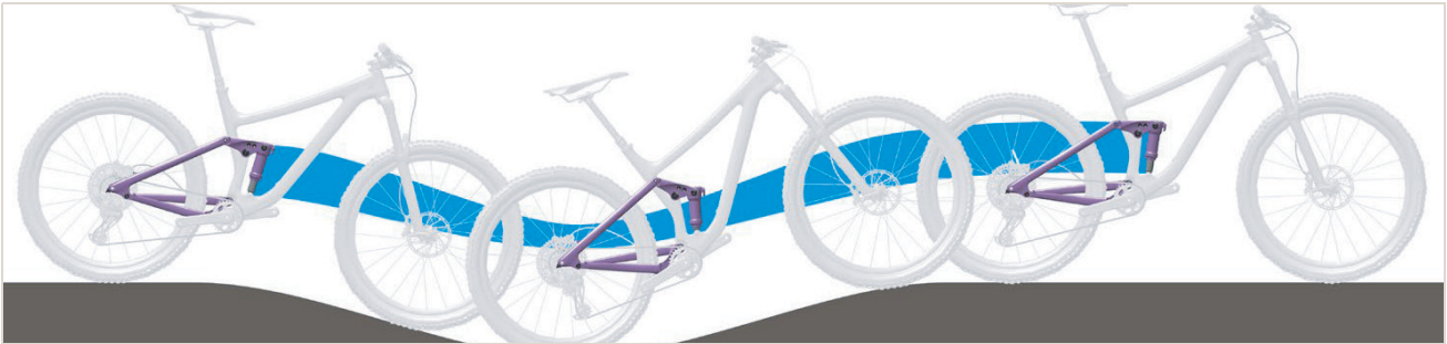
Abbildung 267: Zu weiche Federung des Hinterbau-Dämpfers am Berg
