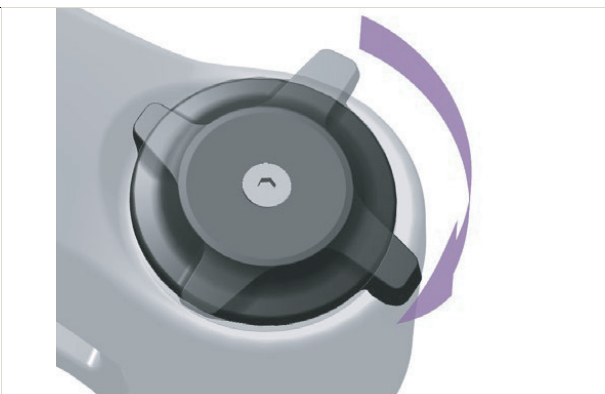
Abbildung 236: Druckstufen-Einsteller härter einstellen
