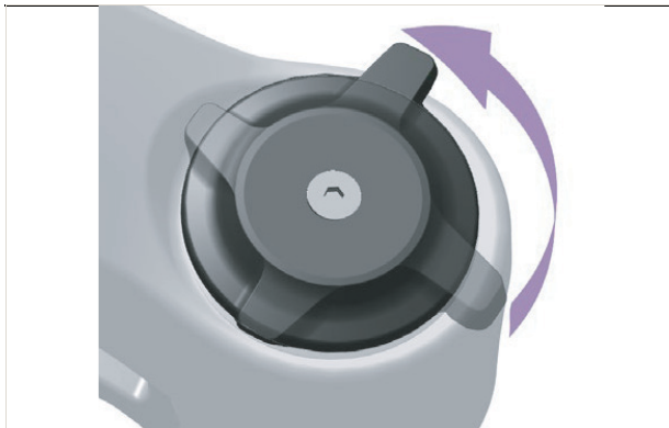
Abbildung 238: Druckstufen-Einsteller weicher einstellen
