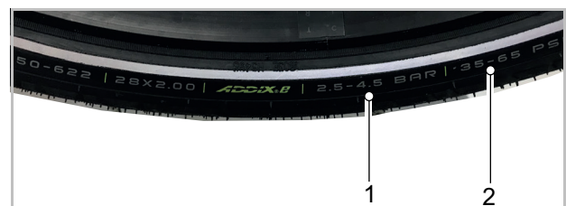
Abbildung 196: Angabe Fülldruck in bar (1) und psi (2)
