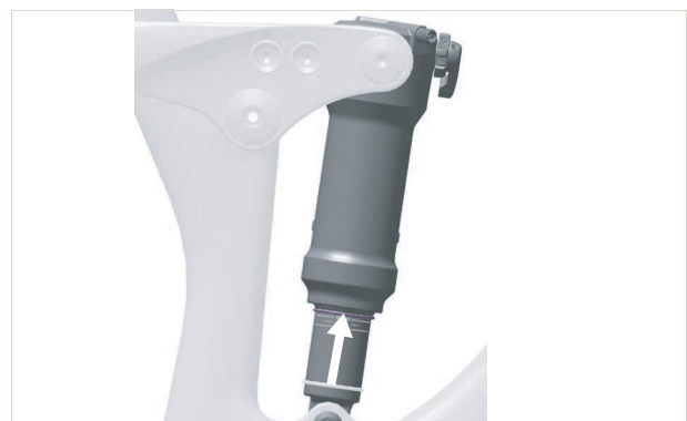
Abbildung 143: O-Ring am Hinterbau-Dämpfer verschieben
