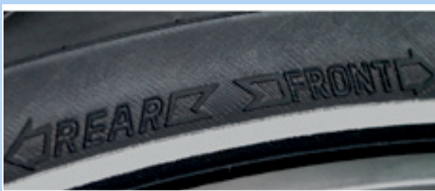
Abbildung 80: Laufrichtungspfeil auf MTB Reifen
