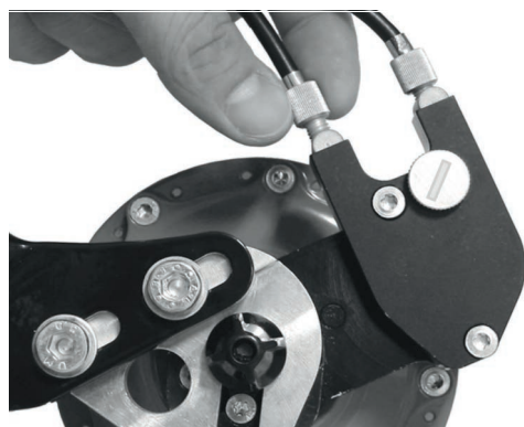
Abbildung 150: ROHLOFF-Naben Versionen mit externer Schaltansteuerung haben die Zugeinsteller an der Seilbox, die sich auf der linken Seite befindet
