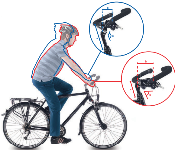
Abbildung 100: Citybike (blau) und Trekkingrad Position (rot) durch Winkeländerung
