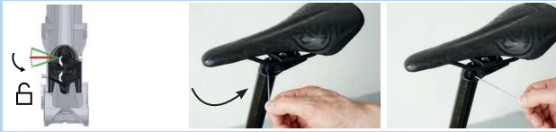
Abbildung 157: Höhenverstellungsbetätigung in „Geöffnete Stellung“ bringen
