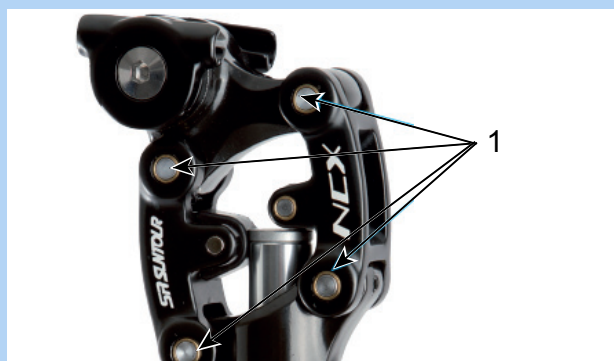
Abbildung 156: Schmierpunkte SR Suntour Feder-Sattelstütze
