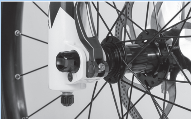
Abbildung 73: Perfekte Lage des Spannhebels
