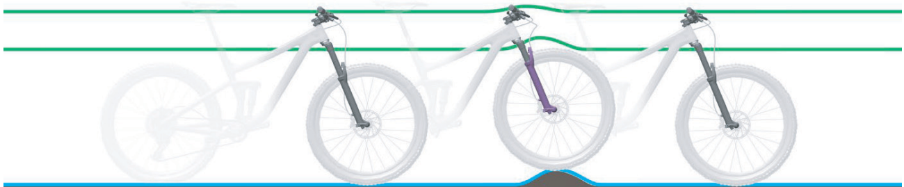
Abbildung 10: Optimales Fahrverhalten der Gabel bei Unebenheiten
