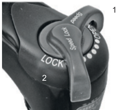
Abbildung 69: Suntour-Druckstufen-Einsteller mit den Positionen OPEN (1) und LOCK (2)
