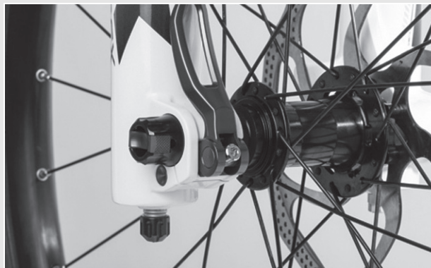
Abbildung 41: Perfekte Lage des Spannhebels
