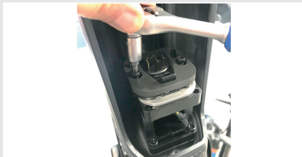
Abbildung 25: Akkuhalter Schrauben lösen
