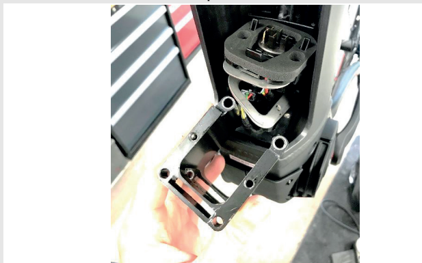
Abbildung 28: PowerTube Adapter herausziehen
