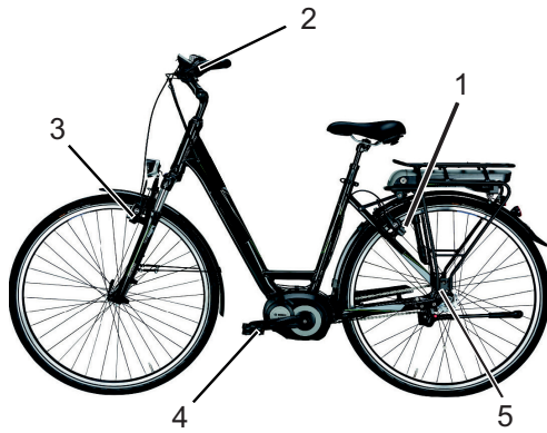
Abbildung 11: Bremssystem mit einer Rücktrittbremse, Beispiel
