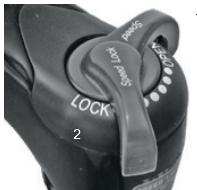
Abbildung 55: Suntour-Druckstufen-Einsteller mit den Positionen OPEN (1) und LOCK (2)
