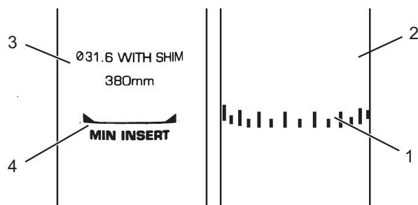
Abbildung 36: Detailansicht Sattelstützen, Beispiele für die Markierung der Mindesteinstecktiefe
