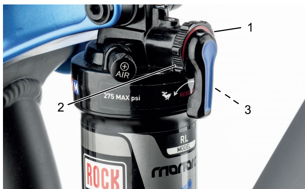
Abbildung 61: Härte des Zugstufen-Dämpfers am Einstellrad (1) des Hinterbau-Dämpfer einstellen
