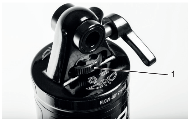
Abbildung 49: Suntour-Zugstufeneinsteller Rad (1) am Hinterbau-Dämpfer
