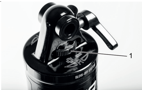
Abbildung 279: Suntour-Zugstufeneinsteller Rad (1) am Hinterbau-Dämpfer
