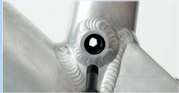
Abbildung 258: Loch der Postpin Schnittstelle
