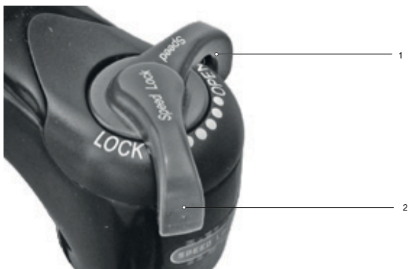
Abbildung 265: Druckstufeneinsteller härter einstellen
