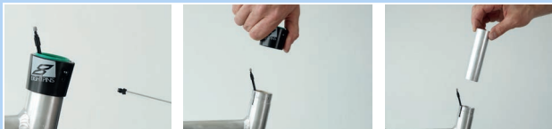
Abbildung 206: Außenhülse und Gleitbuchse ausbauen
