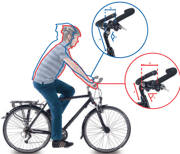
Abbildung 117: Citybike (blau) und Trekkingrad Position (rot) durch Winkeländerung
