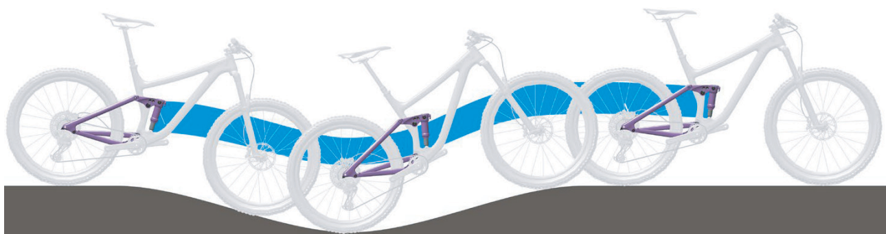
Abbildung 23: Optimales Fahrverhalten des Hinterbau-Dämpfers im hügeligen Gelände
