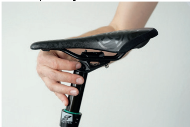
Abbildung 109: Sattelneigung am Einstellrad einstellen
