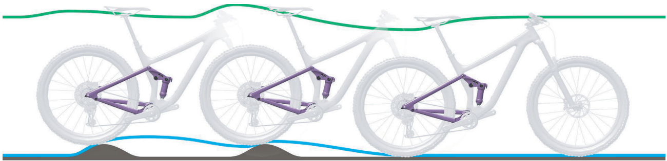
Abbildung 278: Zu langsames Ausfedern des Hinterbau-Dämpfers
