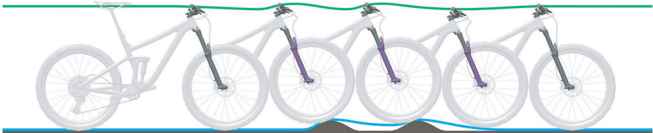
Abbildung 270: Zu langsames Ausfedern der Federgabel
