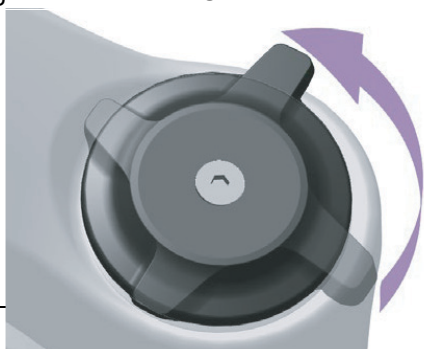
Abbildung 176: Druckstufeneinsteller weicher einstellen
