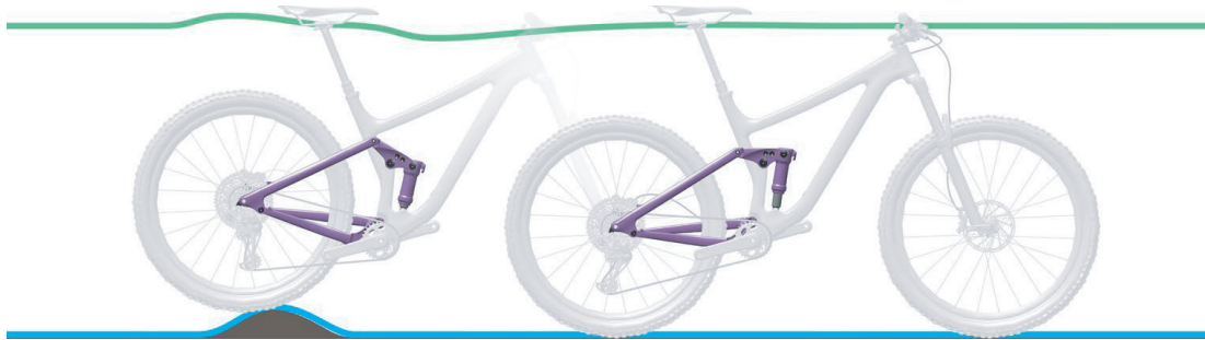
Abbildung 18: Optimales Fahrverhalten des Hinterbau-Dämpfers bei Unebenheiten
