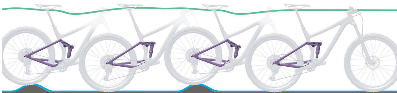
Abbildung 22: Optimales Fahrverhalten des Hinterbau-Dämpfers
