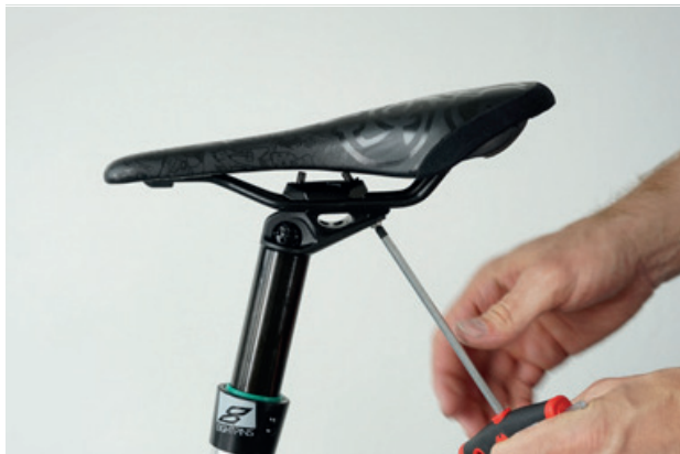
Abbildung 108: Hintere Schraube lockern
