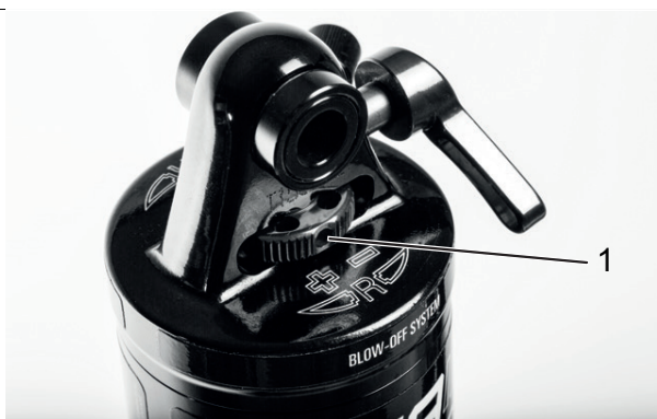
Abbildung 277: Suntour-Zugstufeneinsteller Rad (1) am Hinterbau-Dämpfer
