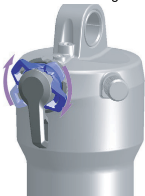
Abbildung 153: Druckstufeneinsteller härter einstellen
