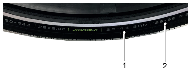
Abbildung 160: Fülldruck in bar (1) und psi (2)
