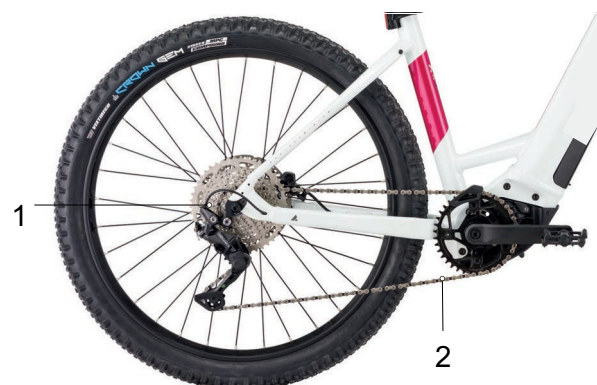
Abbildung 34: Schema Kettenantrieb mit Kettenschaltung
