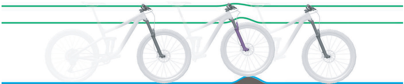
Abbildung 10: Optimales Fahrverhalten der Gabel bei Unebenheiten
