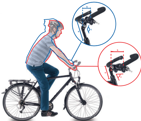
Abbildung 103: Citybike (blau) und Trekkingrad Position (rot) durch Winkeländerung
