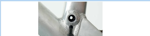
Abbildung 202: Kartusche Ventildeckel befestigen
