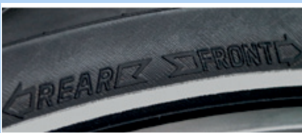
Abbildung 69: Laufrichtungspfeil auf MTB Reifen
