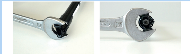
Abbildung 194: Gegen Verdrehen sichern
