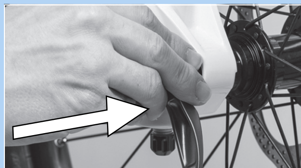
Abbildung 81: Schnellspanner in Pfeilrichtung einschieben
