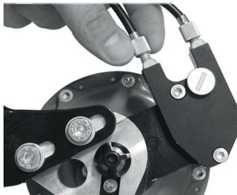
Abbildung 167: ROHLOFF-Naben Versionen mit externer Schaltansteuerung haben die Zugeinsteller an der Seilbox, die sich auf der linken Seite befindet
