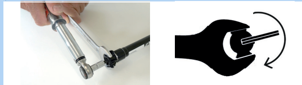
Abbildung 195: Im Uhrzeigersinn einstellen
