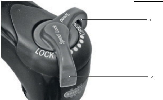
Abbildung 242: Druckstufeneinsteller weicher einstellen
