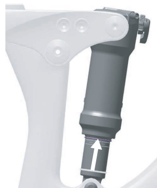
Abbildung 108: O-Ring am Hinterbau-Dämpfer verschieben
