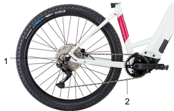
Abbildung 37: Schema Kettenantrieb mit Kettenschaltung
