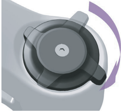
Abbildung 151: Druckstufeneinsteller härter einstellen
