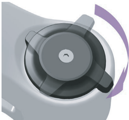
Abbildung 241: Druckstufeneinsteller härter einstellen
