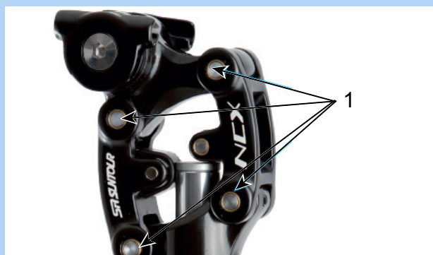
Abbildung 173: Schmierpunkte SR Suntour Feder-Sattelstütze
