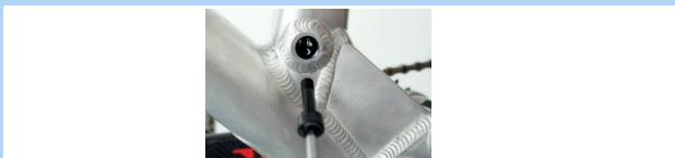
Abbildung 177: Postpin Achse lösen
