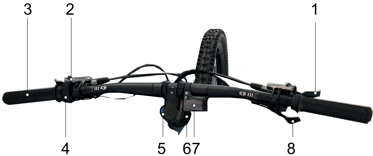
Abbildung 46: Detailansicht Lenker mit SHIMANO SC-E800 Bordcomputer, Beispiel
