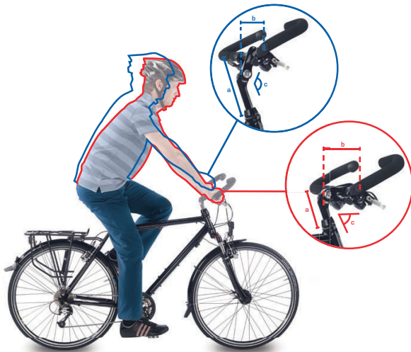
Abbildung 80: Citybike (blau) und Trekkingrad Position (rot) durch Winkeländerung
