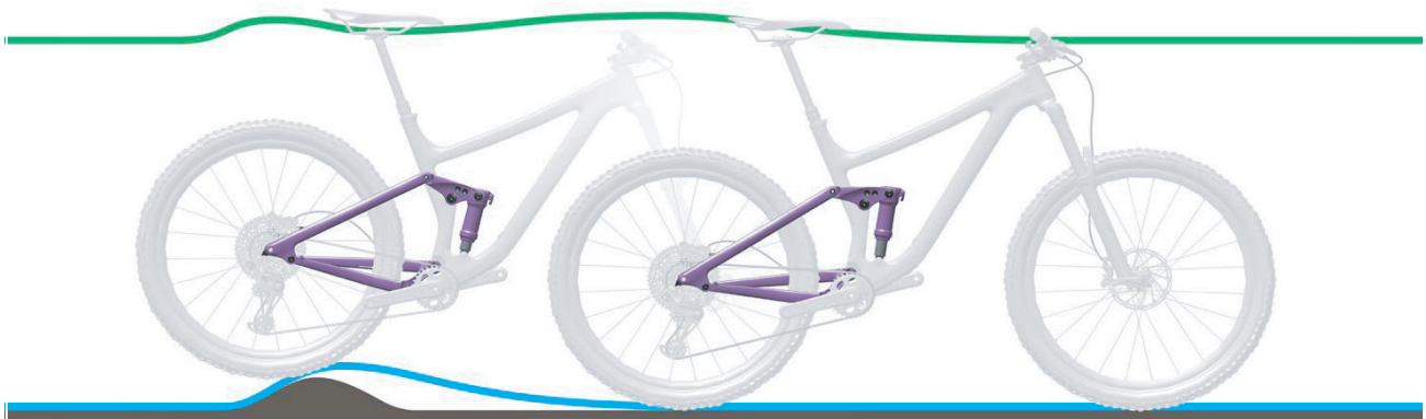
Abbildung 103: Zu harte Dämpfung des Hinterbau-Dämpfers bei Unebenheiten
