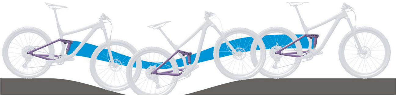
Abbildung 101: Zu weiche Federung des Hinterbau-Dämpfers am Berg
