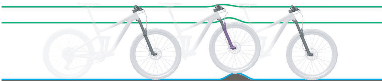
Abbildung 7: Optimales Fahrverhalten der Gabel bei Unebenheiten
