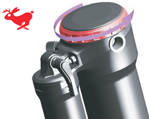
Abbildung 100: Zugstufendämpfer in Richtung Hase drehen
