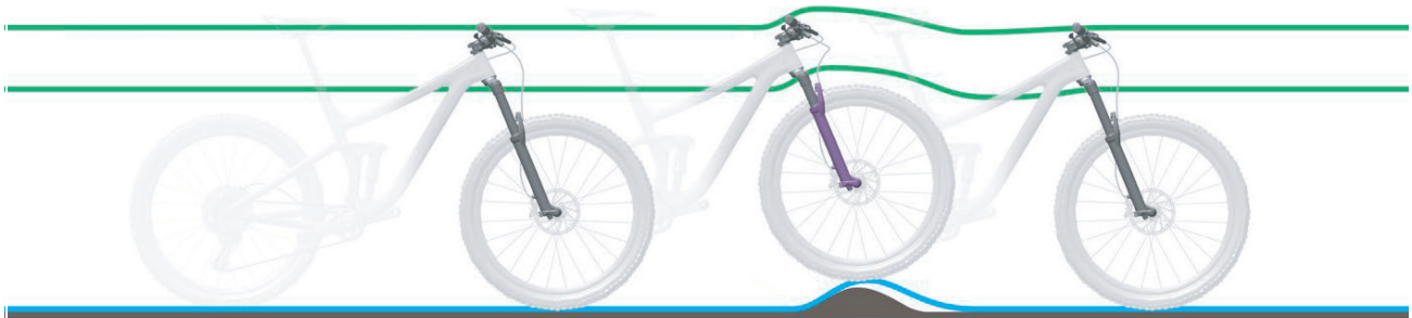
Abbildung 95: Zu harte Dämpfung der Federgabel bei Unebenheiten
