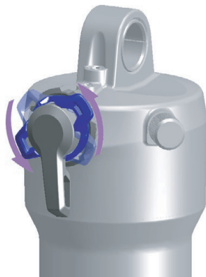
Abbildung 104: Druckstufeneinsteller weicher einstellen
