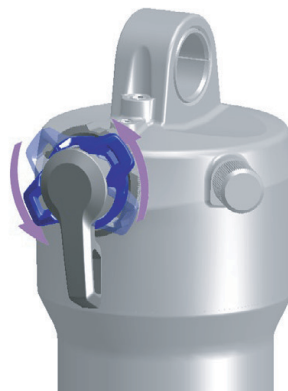
Abbildung 72: Druckstufeneinsteller weicher einstellen
