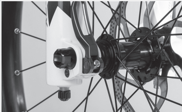
Abbildung 32: Perfekte Lage des Spannhebels
