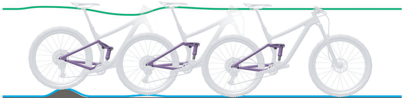
Abbildung 97: Zu schnelles Ausfedern des Hinterbau-Dämpfers
