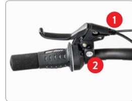
Nach Inbetriebnahme der Bremse und ihrer regelmäßigen Betätigung, kommt es mit der Zeit zur Dehnung des Bremsseils. Zur minimalen Justierung dient die **Nachstellschraube**.
