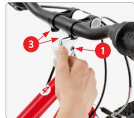
2. Inbusschraube am vorderen Teil des Vorbaus: ermöglicht das Drehen des Lenkerbügels um die eigene Achse (woom 1–3).
