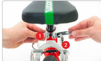
**Schließen:** Bei geöffnetem Spannhebel mit der einen Hand die Einstellmutter im Uhrzeigersinn drehen und dabei mit der anderen Hand den Spannhebel festhalten. Die Mutter muss nun angezogen sein. Lege nun mithilfe des Handballens den Spannhebel so um, dass die Außenseite des Hebels zu sehen ist.
