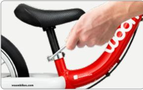
Für das woom 1, 1 PLUS und 2 muss die Höhe durch Öffnen der Sattelklemme mit einem Inbusschlüssel eingestellt werden.
