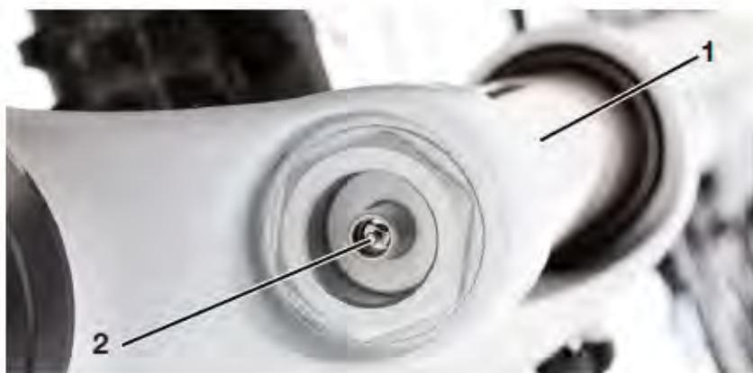
1 Federbein      2 Ventil zur Korrektur des Gabelfülldrucks
