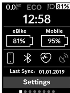
I statusskjerm bildet vises statuslinjen, og i tillegg gjeildende klokkeslett, ladenvået til alle batteriene til Bike og smarttelefonbatteriet hvis smarttelefonen er koblet til via Bluetooth®.
