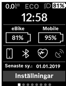
På statusskärmen visas bredvid statusraden även aktuellt klockslag, laddningsnivå för alla batterier på din eBike samt laddningsnivå för din smarttelefon, om den är ansluten via *Bluetooth®*. Under detta visas ev. symboler för aktiverad *Bluetooth®*-funktion eller enheter som är anslutna via *Bluetooth®* (t.ex. en puls mätare). Dessutom visas datum för senaste synkronisering mellan smarttelefon och Kiox. Nederst har du tillgång till **<Inställningar>**.
