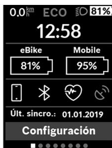
Además de la barra de estado, la pantalla de estado muestra la hora actual, el estado de carga de todos los acumuladores de su eBike y el estado de carga del acumulador de su teléfono inteligente, si el teléfono inteligente está conectado a través de Bluetooth®.
