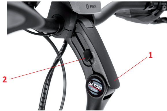
Abbildung 8: Lenkereinstellung bei werkzeuglosem Vorbau
