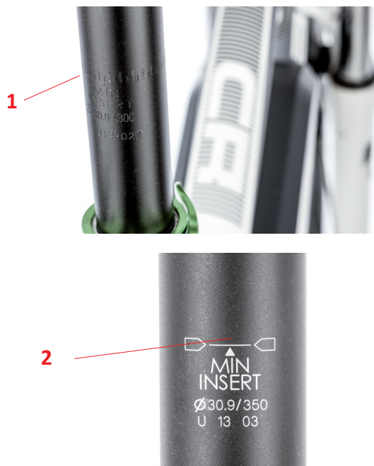
Abbildung 10: Markierungen zur Mindesteinstecktiefe der Sattelstütze
