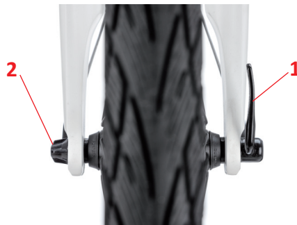
Abbildung 12: Vorschriftsmäßige Montage des Schnellspanners am Vorderrad
