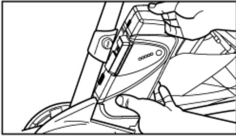
Setzen Sie den Akku, von oben kommend, schräg in die Akkuhalterung ein (Die Akkuladezustandsanzeige muss sich auf der ihnen zugewendeten Seite de Akkus befinden.)
