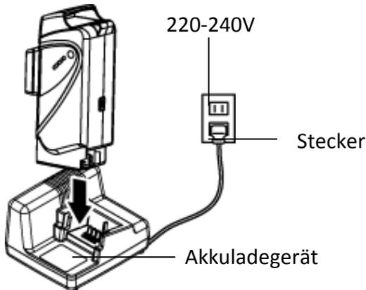
Stecker des Ladegerätes in die Steckdose stecken (220 - 240V) und den Akku in das Ladegerät einsetzen.
