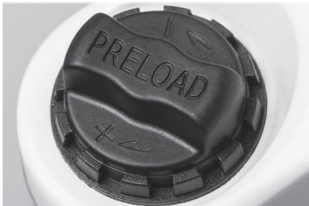
**Abbildung 53:****Einstellrad des Negativen Federwegs auf der Krone der Federgabel**
