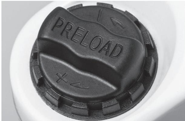
**Abbildung 49:****Einstellrad des Negativen Federwegs auf der Krone der Federgabel**
