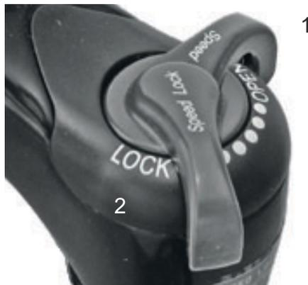
**Abbildung 63:** Suntour-Druckstufeneinsteller mit den Positionen OPEN (1) und LOCK (2)
